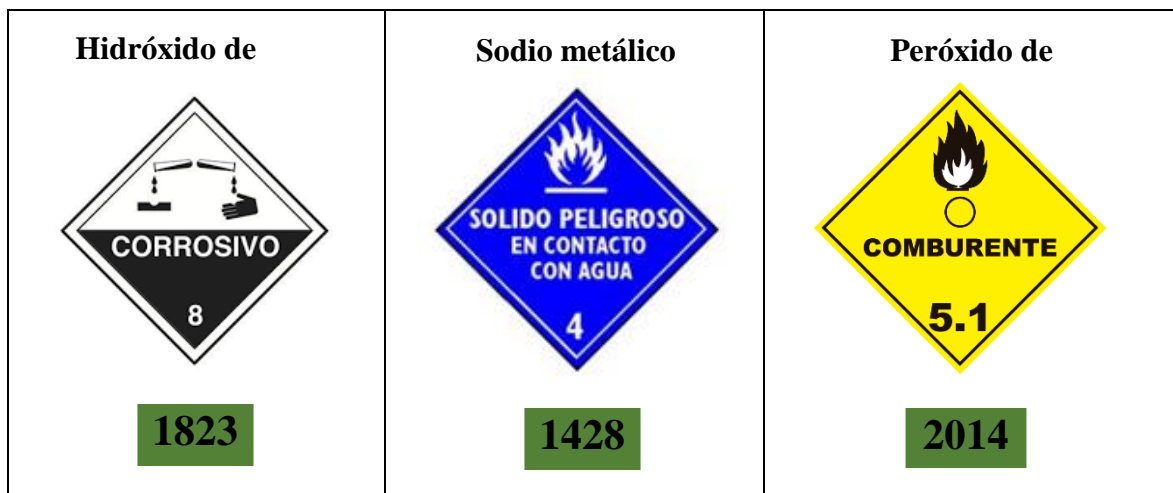
Figura 12 Ejemplo de identificación de la sustancia peligrosa de acuerdo con el UN.
